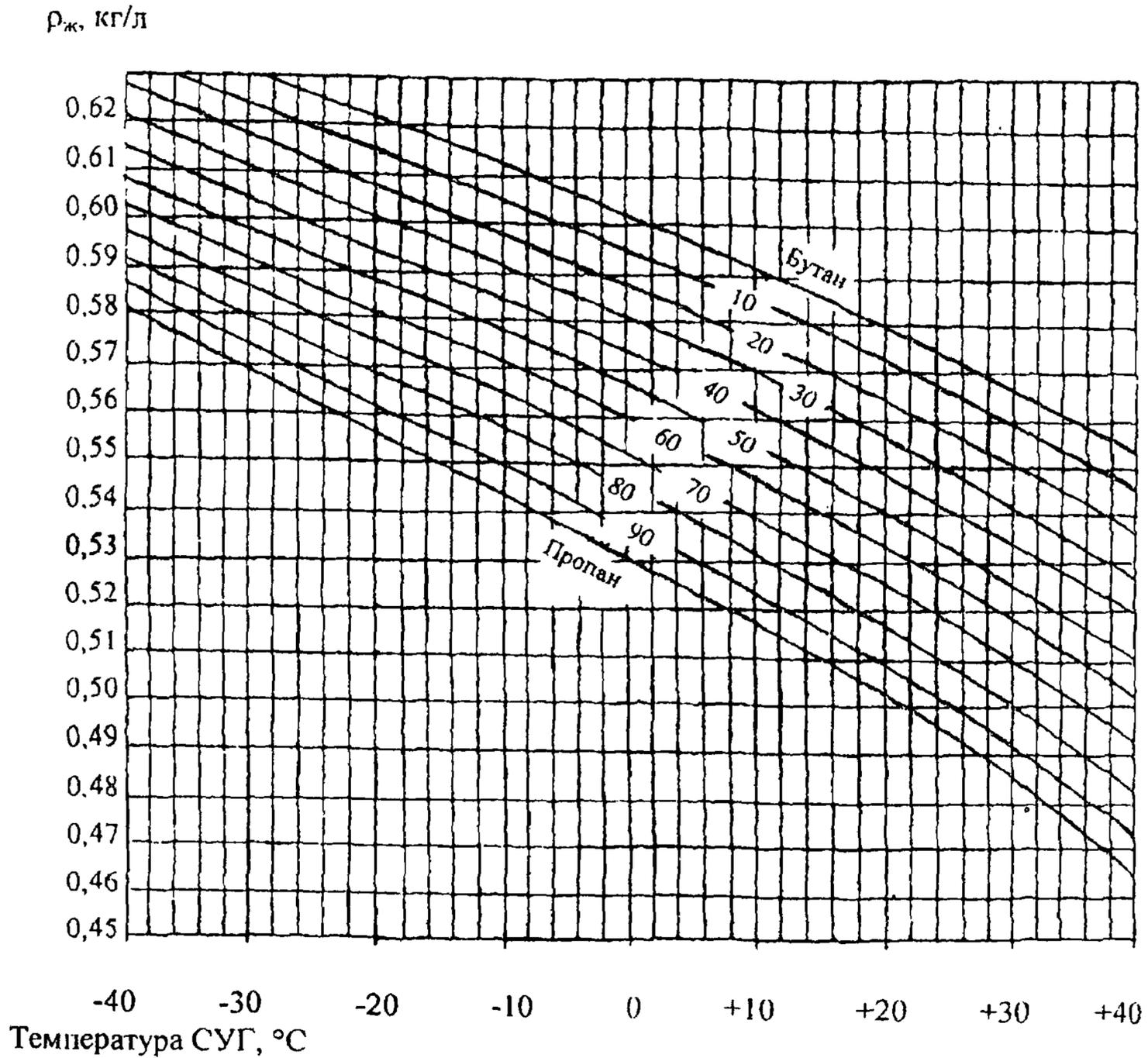
Цифры на кривых – содержание пропана в жидкой фазе в % по массе.
