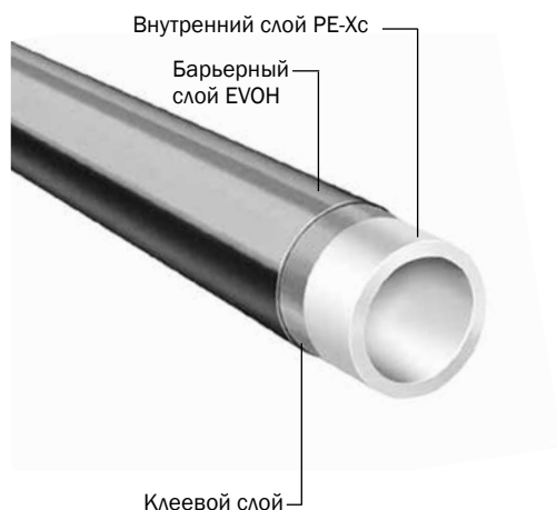
Труба TECEflex PE-Xc/EVOH для отопительных систем
