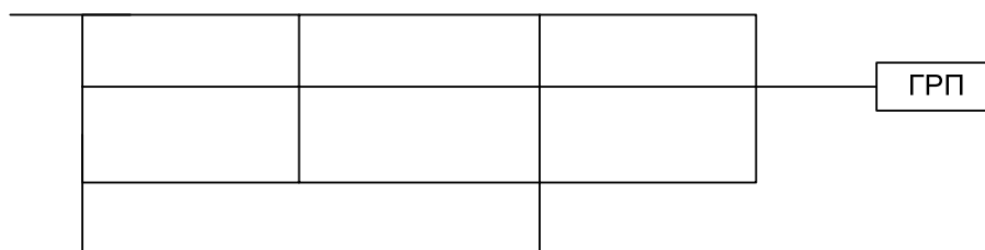
Рис. 1.6 – Принципиальная схема одноступенчатой системы газоснабжения из сетей низкого давления
