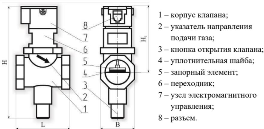
Рисунок 3 – Внешний вид клапана КЗЭУГ.
