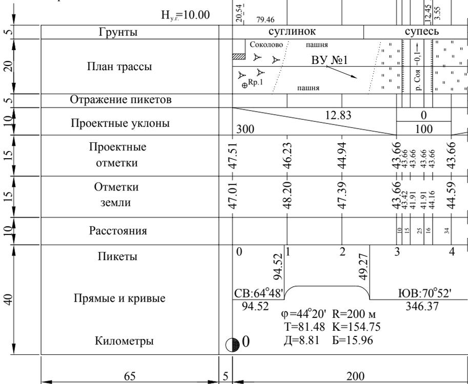
Рис. 1. Фрагмент продольного профиля трассы
