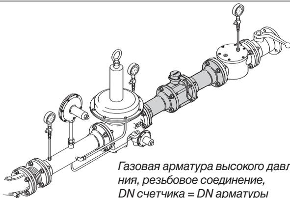
Газовая арматура высокого давления, резьбовое соединение, DN счетчика = DN арматуры
