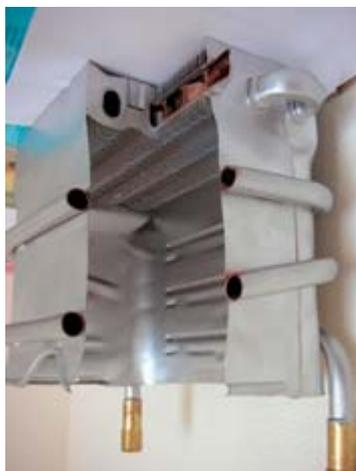
Медный теплообменник способен при значительно меньших размерах передавать больше тепла на единицу его массы
