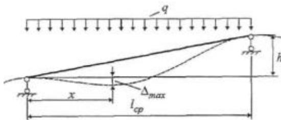
Рис. п. 1.1. Схема прогибов трубопровода под равномерно-распределенной нагрузкой
