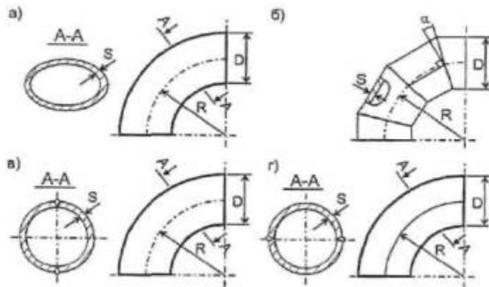
Рис. 3.1. Отводы: а - гнутий; б - секторный; в, г – штампосварной
