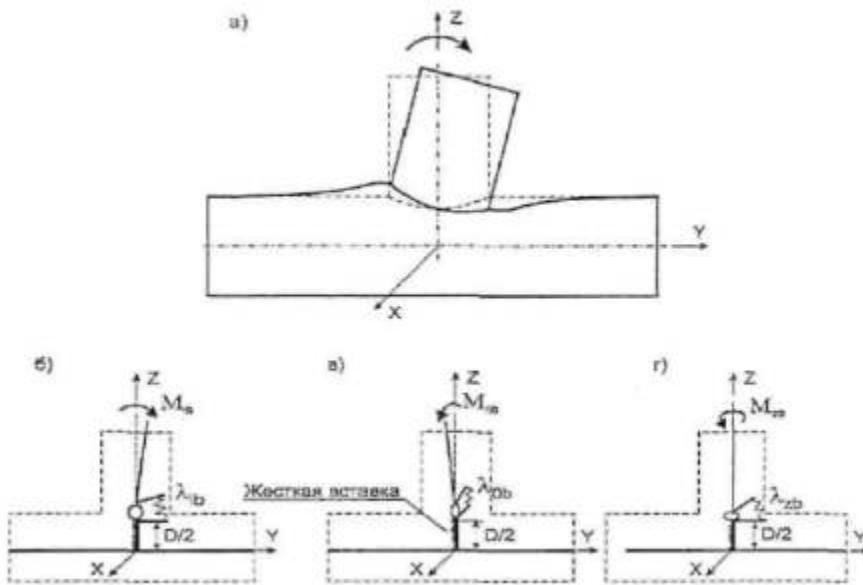
Рис. п. 2.1. Расчетная схема тройника (врезки) под нагрузкой со стороны ответвления
