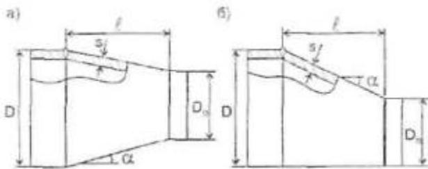
Рис. 3.2. Переходы: а - концентрический, б - эксцентрический
