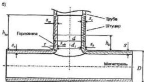
Рис. 3.3. Тройники и врезки: а - сварной тройник (врезка), б - штампованный (штампосварной) тройник
